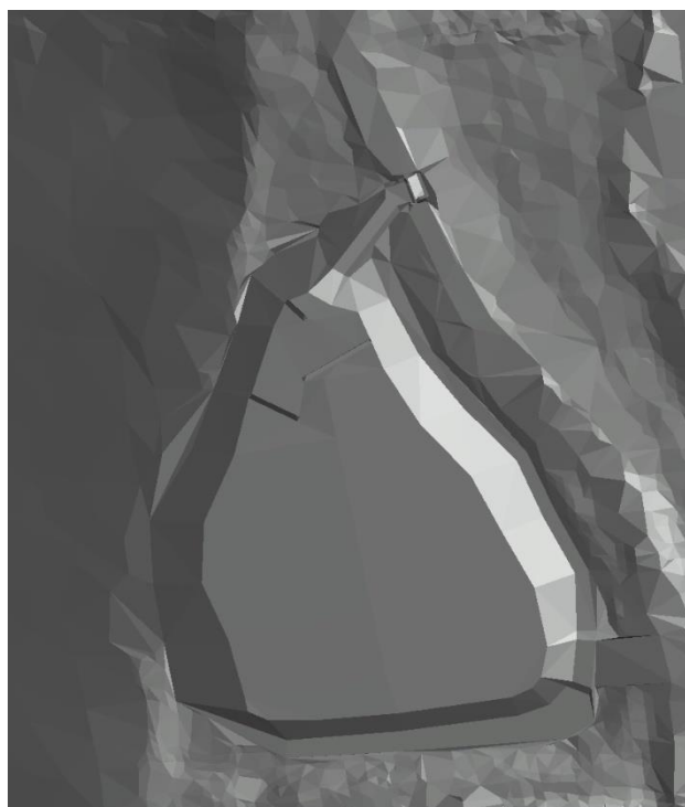
Obrázek 3.1.1 a 3.1.2 Zobrazení DMT 5G a objektů návrhu – TIN model terénu celý a detail
